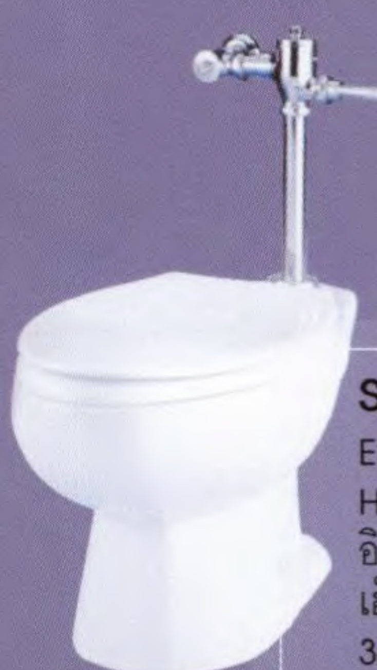
S-2901 RONDO FLUSH รอนโด ฟลัช 360 X 649 X 390 mm. ระยะ 254 mm. จากผนัง ระบบ Syphon+jet
