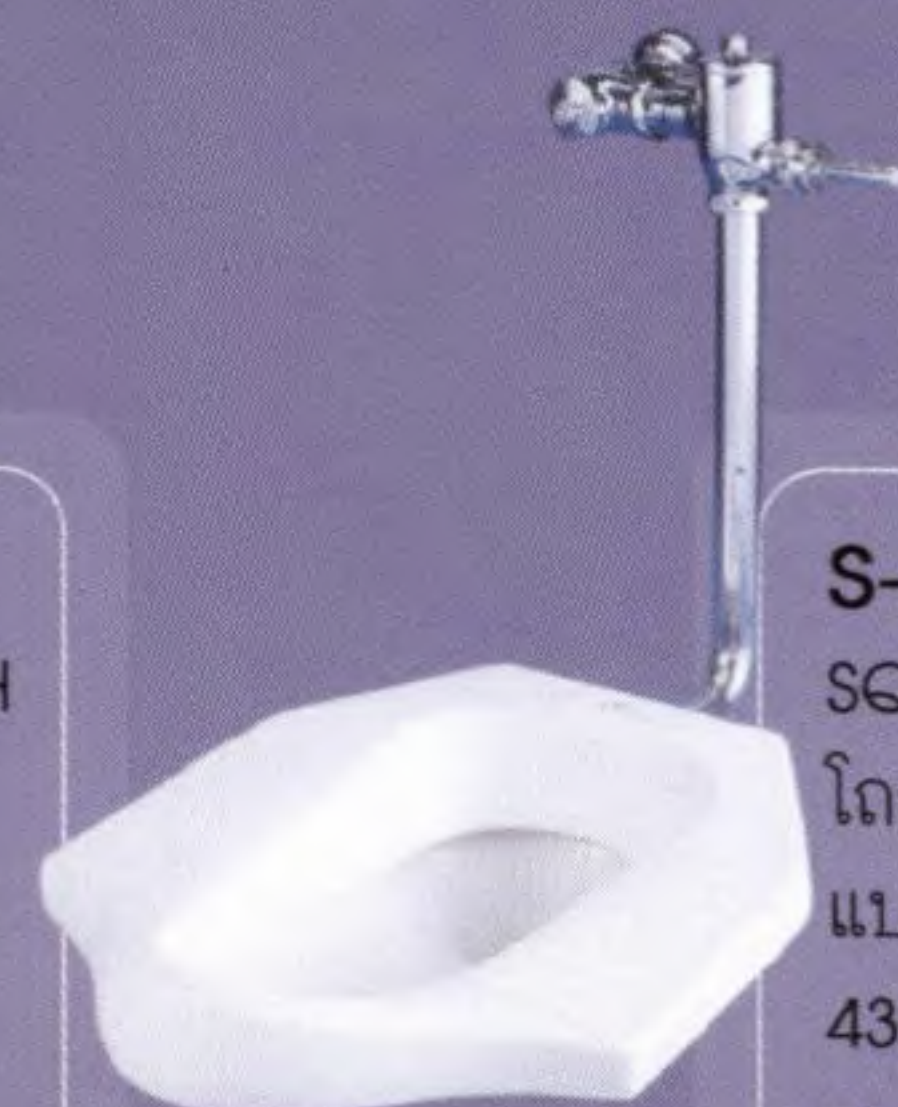
S-5981 PEDESTAL SQUAT FLUSH BACK INLET โถสุขภัณฑ์ นั่งยอง มีฐานแบบฟลัชวาล์ว 430 X 517 X 255 mm. ระยะ 600 mm. จากผนัง ระบบ Washdown
